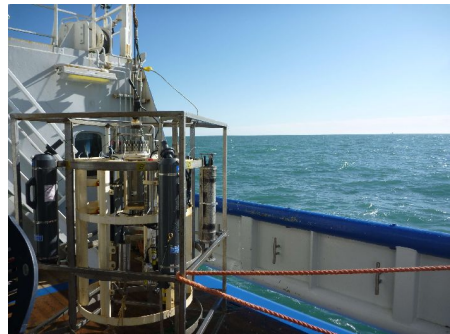
Figuur 1: Het frame met CTD-scanner, OBS, LISST, fluorometer en waterflessen staat aan dek. Op de achtergrond een blauwe Noordzee in de zon in maart 2013. Foto Paolo Stocchi.
